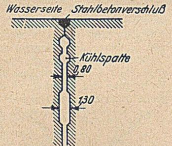
Abb. 13. Ausbildung einer Kuhlspalte (Tölkke: Wasserkraftanlagen Berlin 1938, S. 297).
