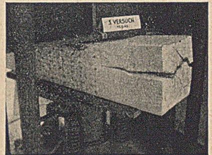
Abb. 4: Versuch 5 bei 30 mm Eindrückung.
