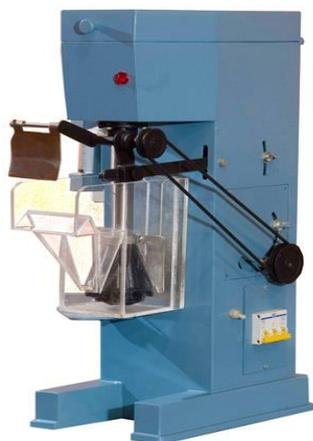
Fig. 1. Flotation machine 137 B-Φ1
