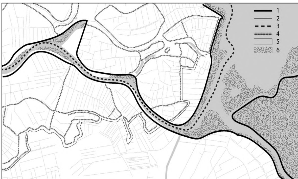
Rys. 7. Uproszczona mapa obszaru Szarpawy na odcinku ujścia do Zalewu Wiślanego. 1 – istniejące odcinki wałów, 2 – przebieg linii brzegowej z przełomu XIX i XX wieku, 3 – granica wewnętrznej delty rzeki Szarpawa, 4 – niezachowane odcinki wałów sprzed depolderyzacji delty, 5 – woda, 6 – przybrzeżne tereny zarastające
