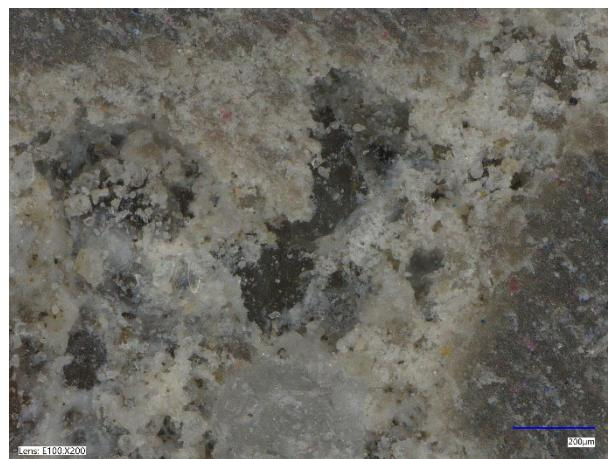
Rys. 10. Przekrój próbki betonowej z kruszywem lekkim PET – skala 200  $\mu\text{m}$
