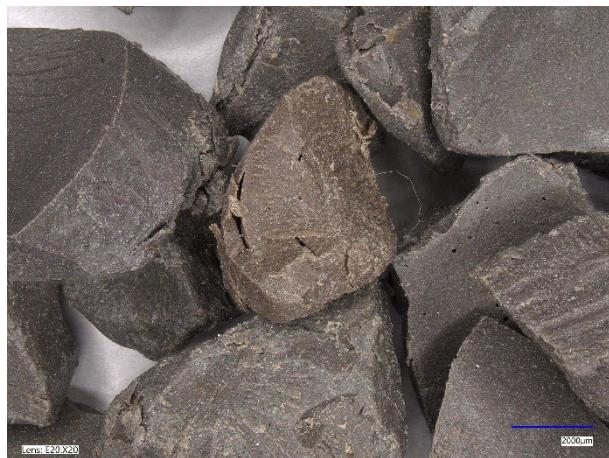
Rys. 7. Kruszywo uzyskane z odpadów tworzyw sztucznych – skala 2000  $\mu\text{m}$
