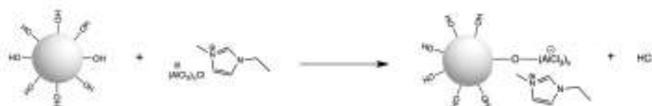
Rysunek 3. Immobilizacja chemiczna cieczy jonowej na powierzchni krzemionki poprzez kation lub anion. Przywiązanie IL do nośnika można uzyskać poprzez bezpośrednią immobilizację IL (A) lub poprzez budowanie struktury IL na nośniku (B).
